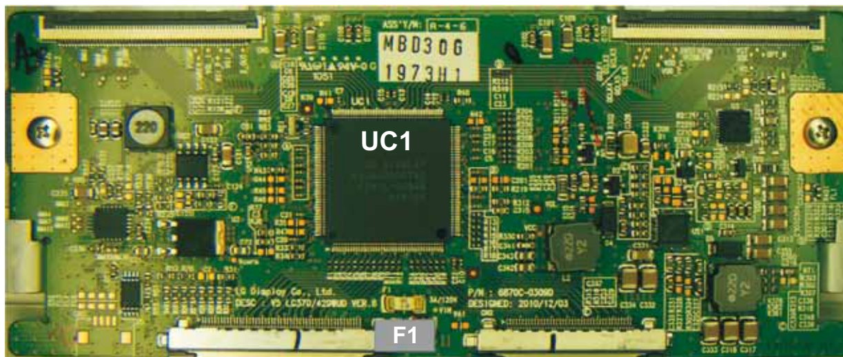
Fot.1. Widok płyty panelu T-CON od strony elementów
